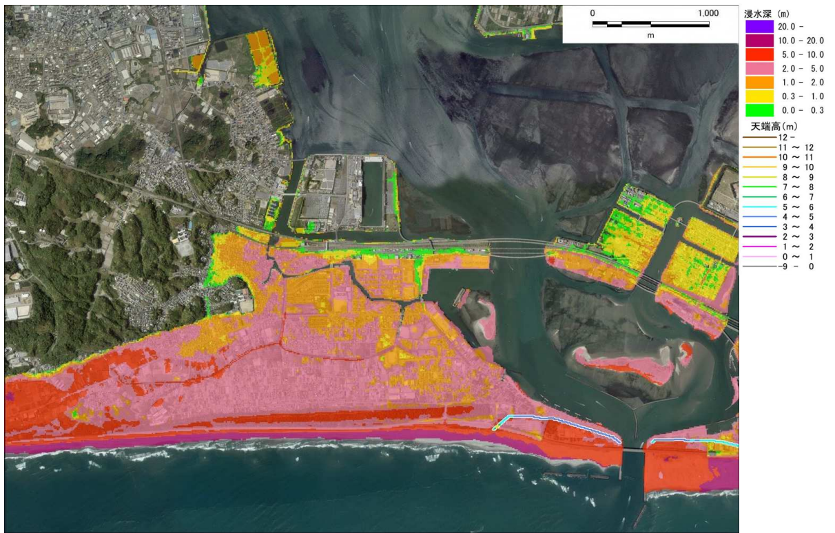
本業務で求めた最大浸水深（外力：レベル2、最大クラスケース①）
