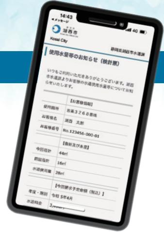
湖西市では、デジタル技術を活用した業務の効率化・市民サービスの向上を図るため、令和9年度までに市内全域に水道スマートメーターを設置します。併せて、さらなるDX化・ペーパーレス化の推進のため、今まで紙でお届けしていた「使用水量等のお知らせ(検針票)」を、SMS(ショートメッセージサービス)でお知らせするサービスを令和5年4月から開始しました。
