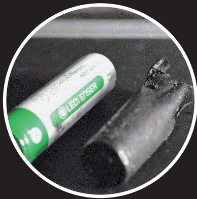
▲出火原因と考えられるリチウムイオン電池
