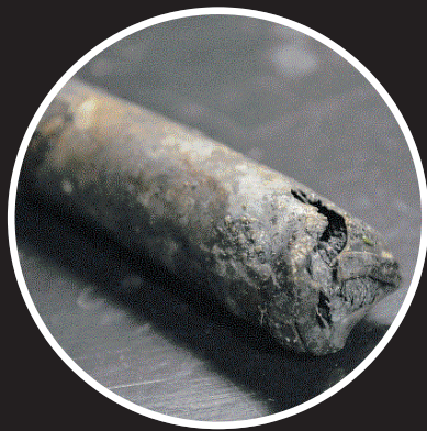
▲出火原因と考えられるリチウムイオン電池
