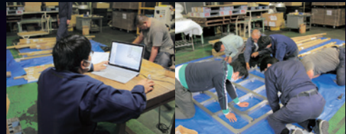
▲1号機は鉄の扱いに苦戦した経験から、2号機は土台部分にもアルミ素材を選択。軽量化が可能に。
