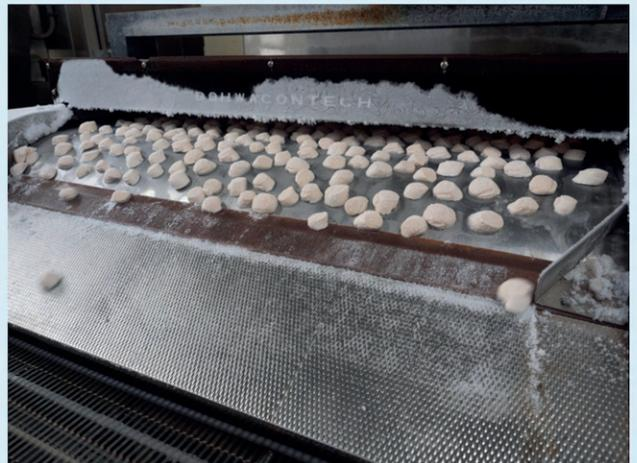
トンネルフリーザーという急速冷凍機で冷凍します。ホタテ同士がくっつかないように少し離して並べます。冷凍後は選別、包装してみなさんにお届けします。
