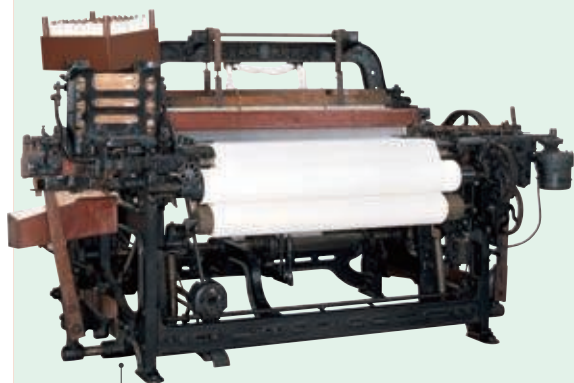
むていしひがえしき 無停止杼換式 豊田自動織機(G型)
