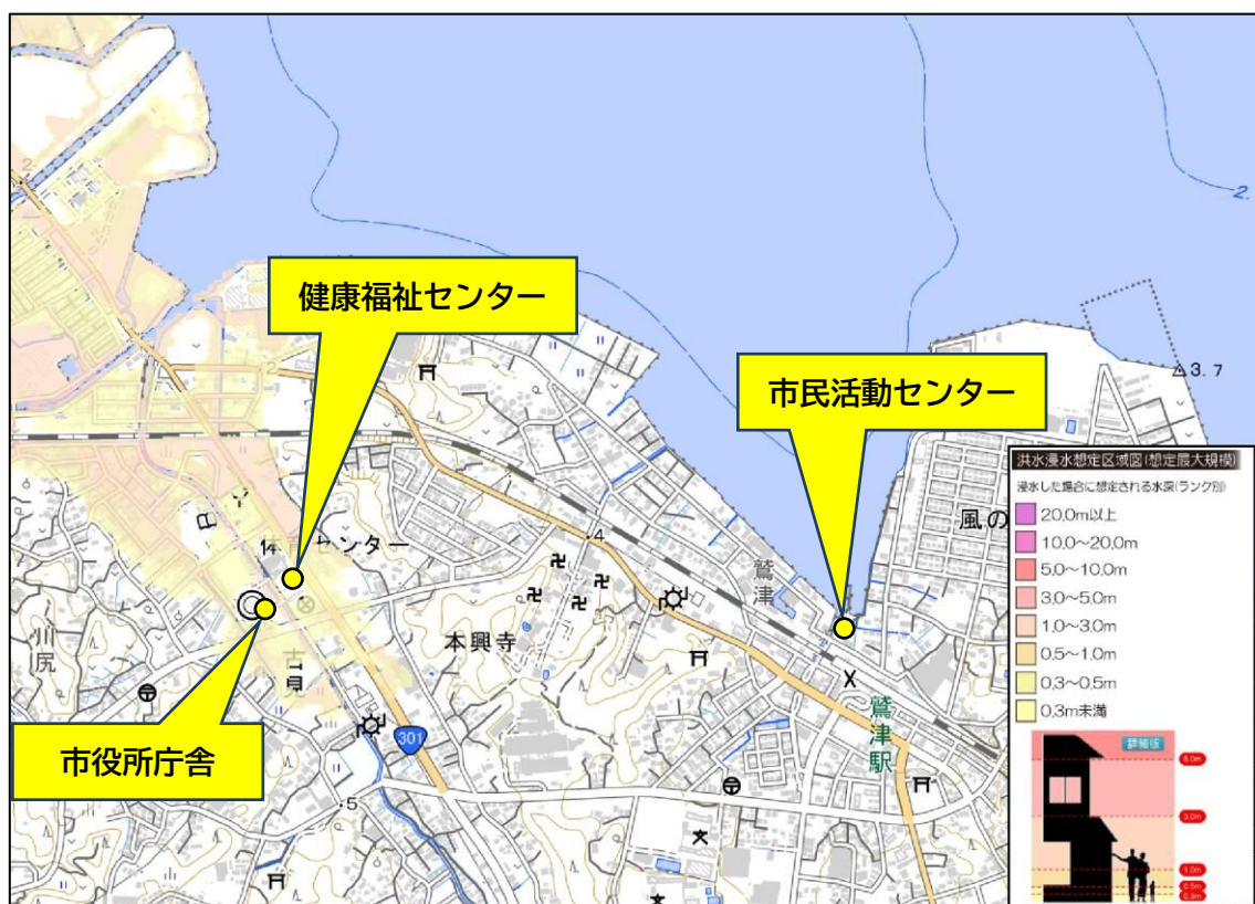
図 2-5 洪水浸水想定区域図（その他河川）（出典：静岡県地理情報システム）（令和 7 年 3 月）
