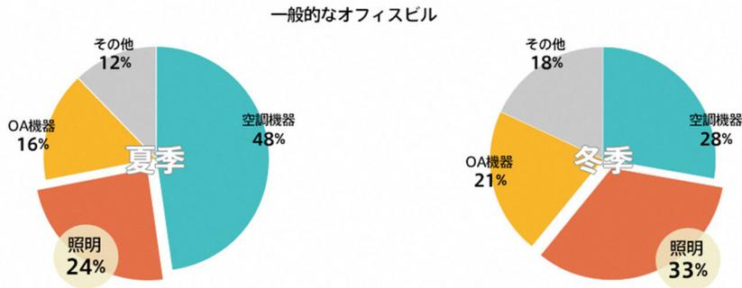
図 8-1 オフィスビルの電力消費割合
