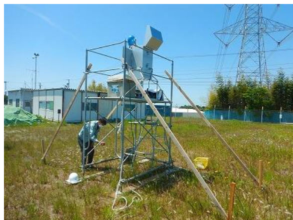
【ダイオキシン類測定（笠子廃棄物処分場）】
