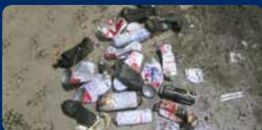
▲令和4年9月の収集車火災の原因とみられるカセットボンベ
