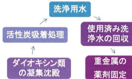
洗浄水の浄化設備
