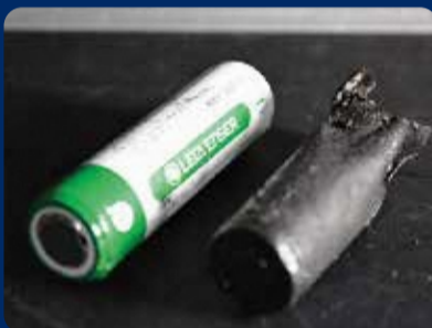
▲火災の原因(リチウムイオン電池)
