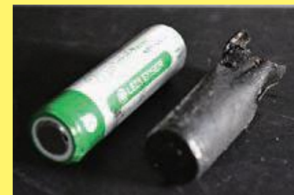
A causa do incêndio (bateria cilíndrica de íon-lítio)
