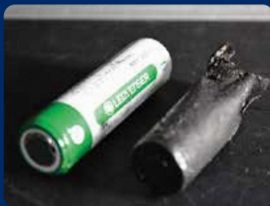
▲Causa do incêndio (Bateria de íon lítio)
