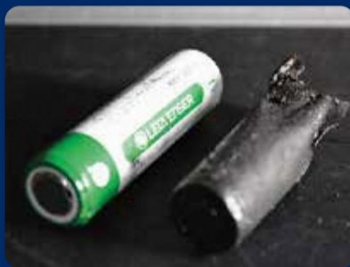
▲Causa do incêndio (Bateria de íon lítio)
