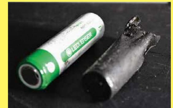
La causa del incendio (batería de iones de litio)
