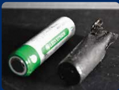
▲Causa del incendio (pila de iones de litio)
