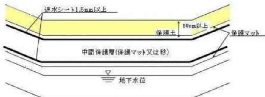
図 1.7 法面部の遮水構造
