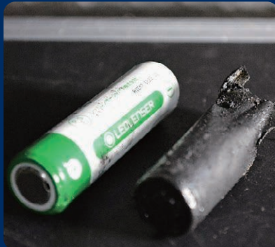
▲Penyebab kebakaran (baterai lithium-ion)
