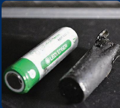
▲Penyebab kebakaran (baterai lithium-ion)
