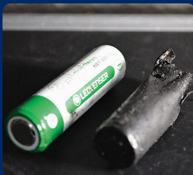
▲Causa do incêndio (Bateria de íon lítio)
