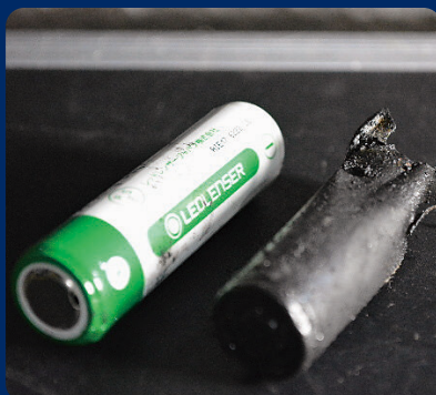
▲Causa do incêndio (Bateria de íon lítio)
