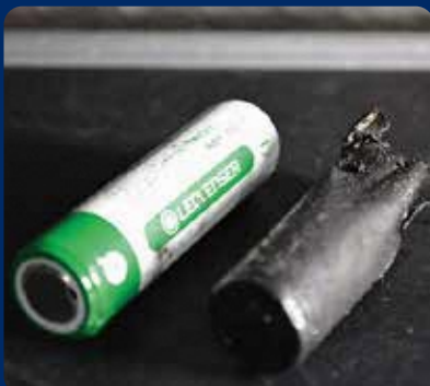
▲火災の原因(リチウムイオン電池)
