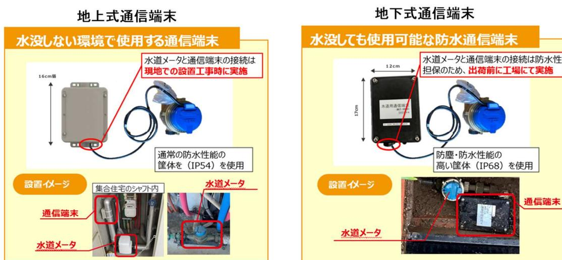
図 2-2 地上式通信端末および地下式通信端末について
