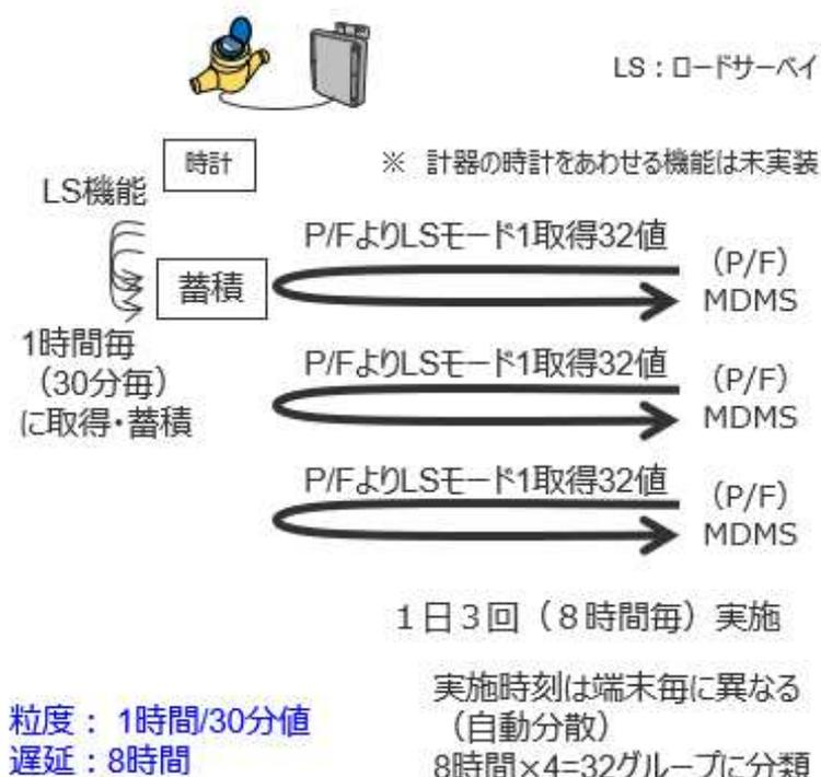
図 2-22 ロードサーベイデータ一括取得方式 (変更後)
