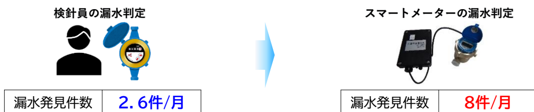
図 3-5 水道スマートメーター導入の概要
