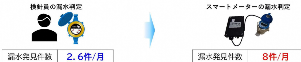
図 3-5 水道スマートメーター導入の概要
