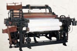
むていしひがえしきとよだじどうしよつき ●無停止杼換式豊田自動織機(G型) 1924年(大正13年)
