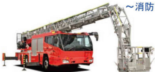
35m級 先端屈折はしご付消防ポンプ自動車 モリタ MLLAH5-35S
