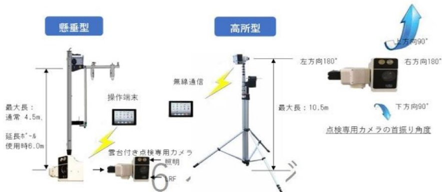
ポールユニットに設置した橋梁点検ロボットカメラ
