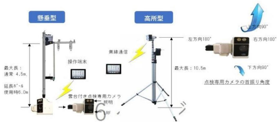
ポールユニットに設置した橋梁点検ロボットカメラ (点検専用カメラは、懸垂型、高所型において共通)
