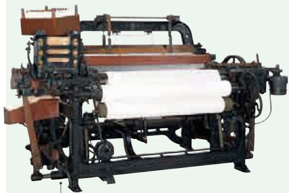
むていしひかえしき 無停止杼換式 豊田自動織機(G型)
